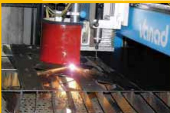
Изготавливать детали из толстого (до 40мм) листа позволяет новый станок фирмы VANAD, обеспечивающий резку деталей в защитной кислородной среде с высоким качеством, скоростью и точностью.
