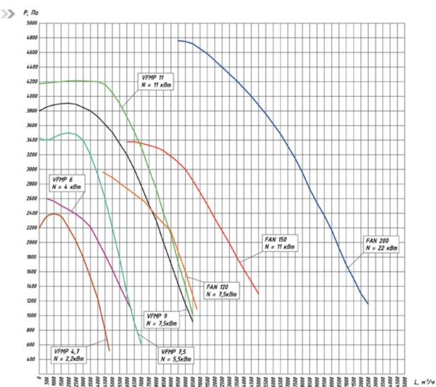
Вентиляторы серии FAN поставляются в шумоизолируемом корпусе и с частотным преобразователем скорости вращения вентилятора.
