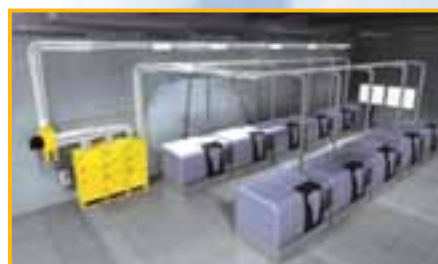
Система вытяжных устройств от источников образования масляного тумана, подсоединенная к фильтру МЕ
