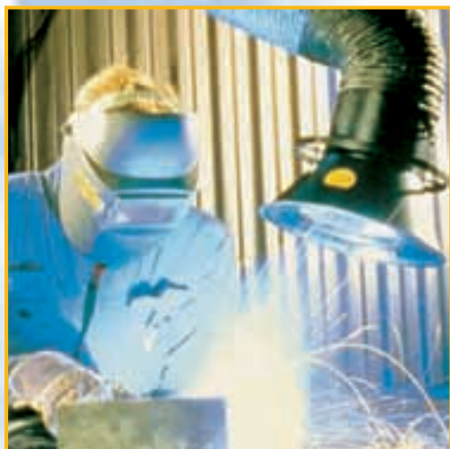
Применение LM-2 для улавливания и удаления сварочных дымов.
