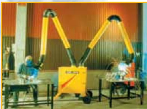
Фильтровентиляционный агрегат EMK, оснащенный двумя вытяжными устройствами KUA.
