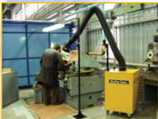
г. Электросталь. Завод "Элемаш". Участок шлифовки. Механический фильтр MFC-1000.
