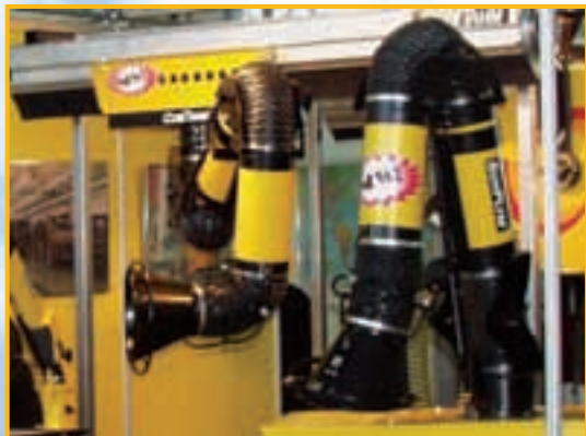
Вытяжное устройство KUA-M-2H на вытяжном рельсе и вытяжное устройство KUA-M-2S установленное на передвижном фильтре.
