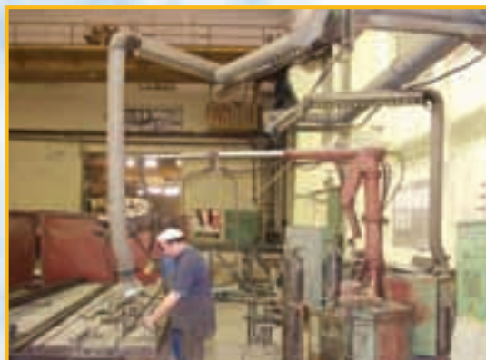
Санкт-Петербург. ЗАО "Латрэс". Производство эскалаторов. Консольно-поворотное вытяжное устройство УК.
