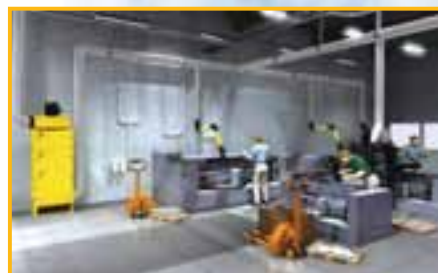
Фильтр, подсоединенный к центральному вентилятору для обслуживания нескольких станков
