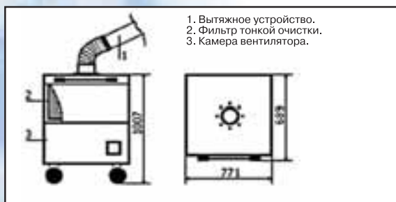
г. Электросталь. Завод "Элемаш". Участок шлифовки. Механический фильтр MFC-1000.
