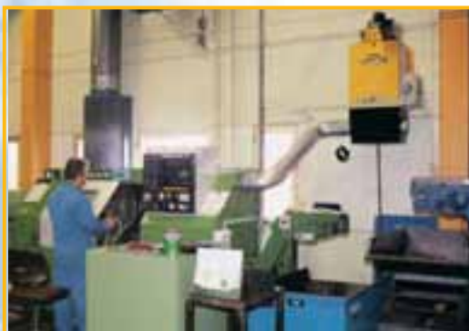
Завод "Samhall" в Швеции. Индивидуальный фильтр для обслуживания станка с ЧПУ.
