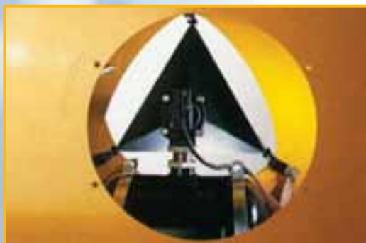
Стабилизатор Ram-Air равномерно распределяет поток сжатого воздуха по всей поверхности кассеты, что позволяет максимально очистить кассету, обеспечивая непрерывность работы фильтра и уменьшить расход сжатого воздуха.
