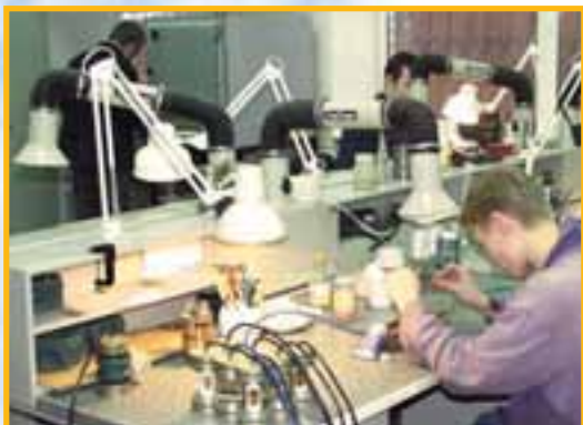
Москва. "ТЕНЗО-М" - весоизмерительная компания. Участок сборки. Настольные вытяжные устройства, окрашенные порошковой краской в белый цвет.
