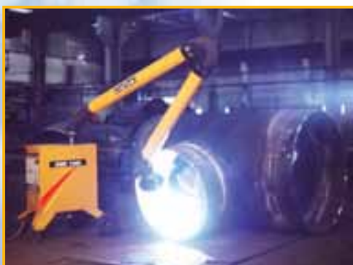
Челябинск. ОАО "Трубодеталь". Передвижной фильтровентиляционный агрегат EMK1400.
