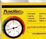
5. Каждый модуль фильтра с фильтрующим элементом тонкой очистки оборудован блоком датчиков и стрелочным индикатором уровня давления в фильтрующем элементе.
