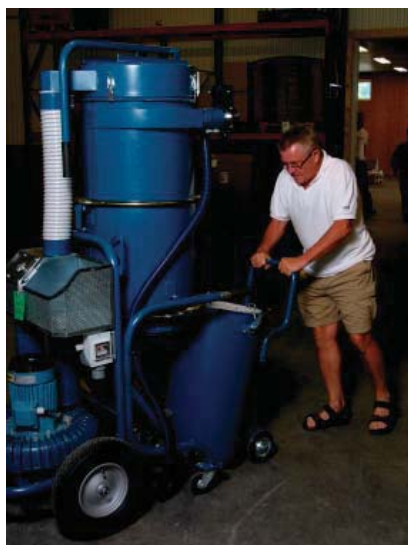
При разгрузке контейнера он отстегивается и снимается с устройства. После этого мешок можно вынимать из контейнера.
