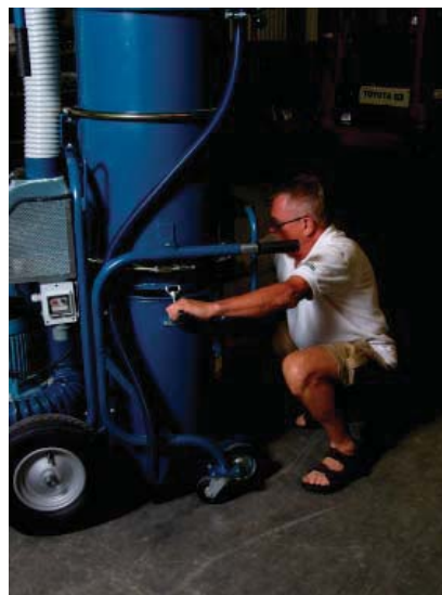
Контейнер присоединяется к устройству двумя зажимами.
